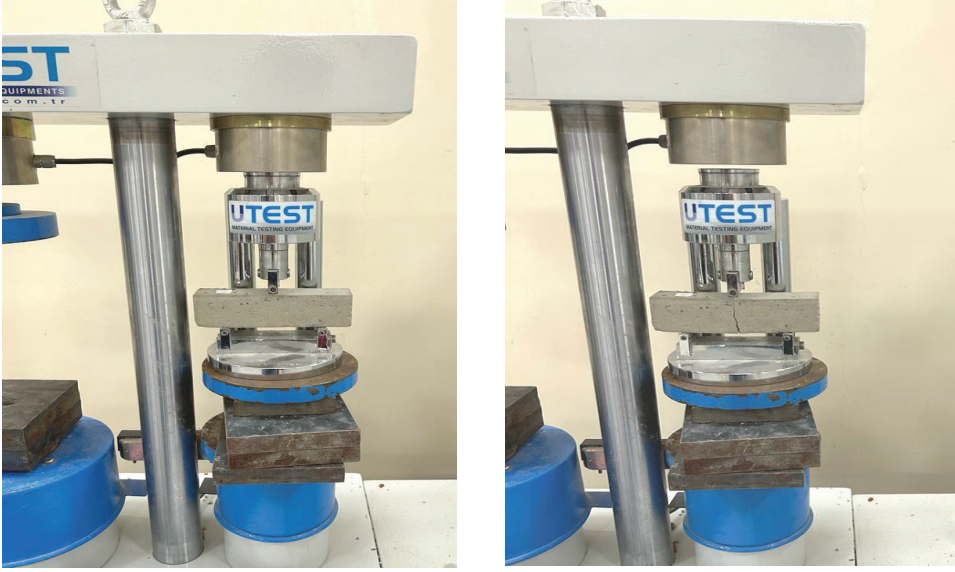
Şekil 6. REVCON elyaf katkılı test örneklerinin eğilme dayanımı analizinden bir görünüm.
