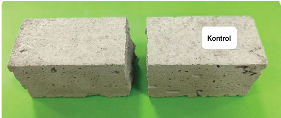
Şekil 8. Eğilme dayanımı testi sonrası Kontrol harcı örneği genel görünümü.
