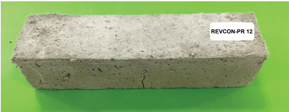
Şekil 11. Eğilme dayanımı testi sonrası REVCON-PR 12 elyaf katkılı harç örneği genel görünümü.
