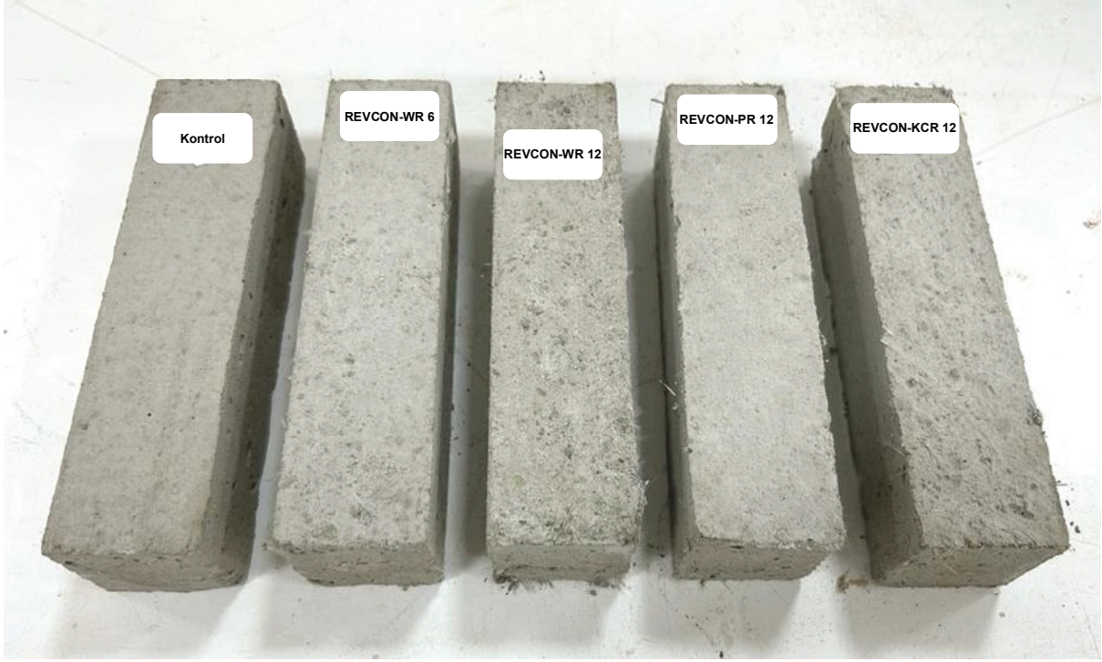
Şekil 4. REVCON elyaf katkılı çimento esaslı test örneklerinin 28 gün sonra genel görünüşleri.
