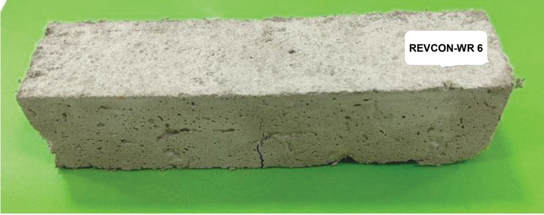
Şekil 9. Eğilme dayanımı testi sonrası REVCON-WR 6 elyaf katkıli harç örneği genel görünümü.
