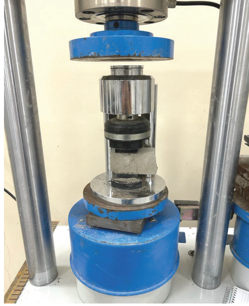
Şekil 15. REVCON elyaf katkılı test örneklerinin basınç dayanımı analizinden bir görünüm.
