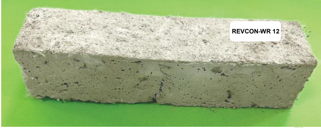
Şekil 10. Eğilme dayanımı testi sonrası REVCON-WR 12 elyaf katkılı harç örneği genel görünümü.
